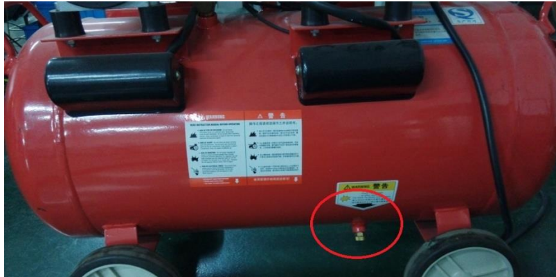
图6-3 空气压缩机排水
