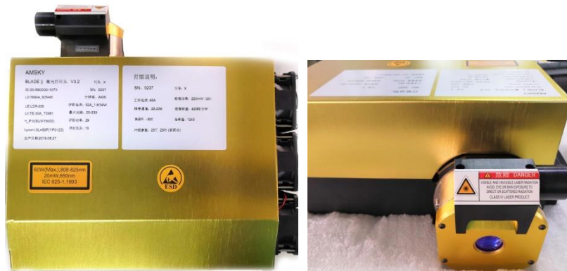
图2-3 Aurora T1200+光学平台激光标签位置
